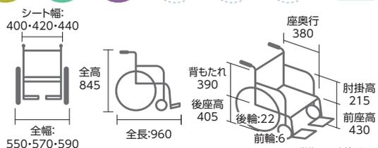
※クッション(30mm)込み寸法 ※折りたたみ時/全長780×全高670×全幅320mm
