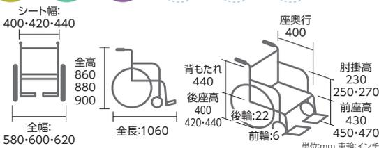
※クッション(30mm)込み寸法 ※折りたたみ時/全長770×全高650/670/690×全幅340mm
