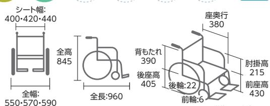
※クッション(30mm)込み寸法 ※折りたたみ時/全長920×全高670×全幅320mm
