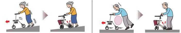
坂道では自動的に抑速ブレーキが作動して加速を抑えるので安心して歩行可能
